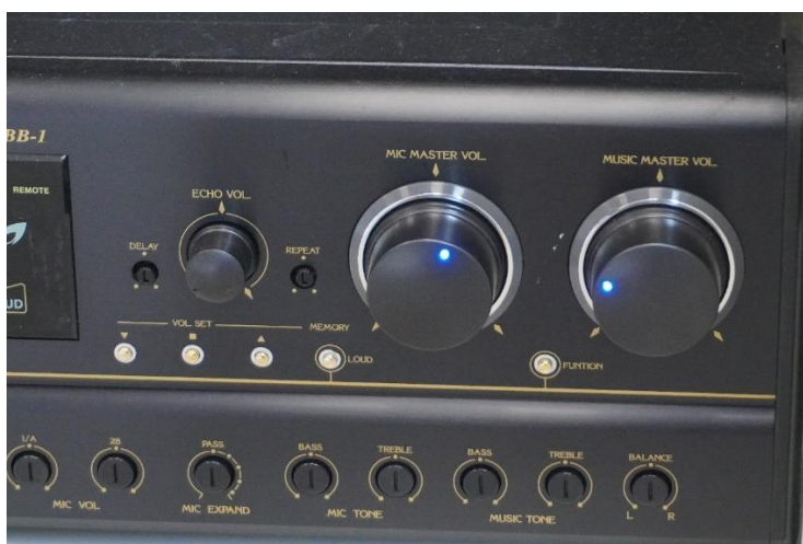
左邊為控制麥克風音量，右邊為控制電腦音量， 小型教室無控制面板 ，
